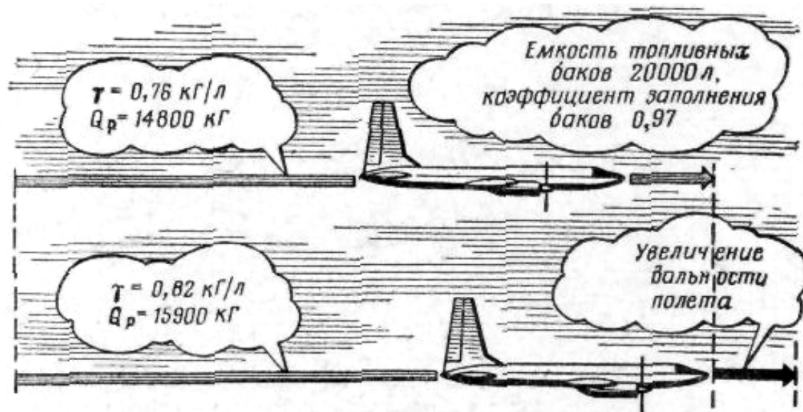
Рис. 2.17. Зависимость располагаемого запаса топлива и дальности полета от удельного веса топлива
